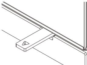
エアコントロールレバーが手前まで引いた状態です。この位置では、空気孔は全開状態で、たくさんの空気を取り込みます。ポジション3は、最初の着火時のみに使用し、通常燃焼時には使用しません。
