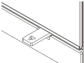
エアコントロールレバーが中間の位置にある状態です。この位置では、上部からの空気を多く取り込みます。通常燃焼時はこの位置で行い、薪の状態や温度を見ながらポジション2と1の間でレバーを操作し、火力を調整します。
