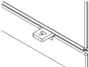
エアコントロールレバーが奥まで押された状態です。この位置では、空気孔はほぼ閉じている状態で、最低量の空気を取り込みます。
