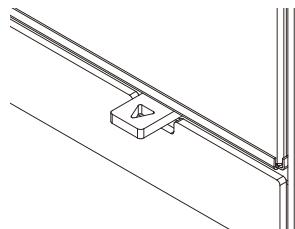
エアコントロールレバーが奥まで押された状態です。この位置では、空気孔はほぼ閉じている状態で、最低量の空気を取り込みます。
