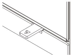
エアコントロールレバーが中間の位置にある状態です。この位置では、上部からの空気を多く取り込みます。通常燃焼時はこの位置で行い、薪の状態や温度を見ながらポジション 2 と 1 の間でレバーを操作し、火力を調整します。
