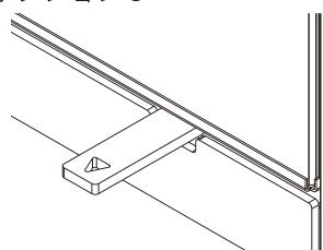
エアコントロールレバーが手前まで引いた状態です。この位置では、空気孔は全開状態で、多くの空気を取り込みます。ポジション 3 は、最初の着火時にのみに使用し、通常燃焼時には使用しません。
