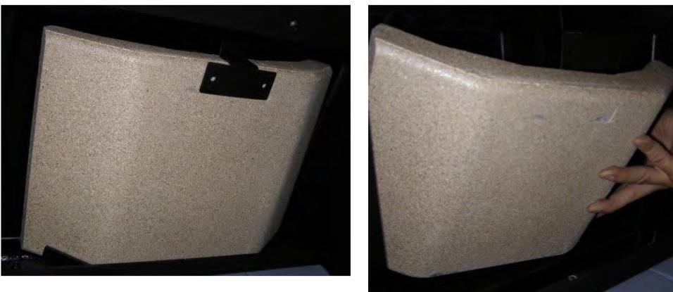
慎重にバッフル板を取り外します。後ろ側を上方向に押してください。
