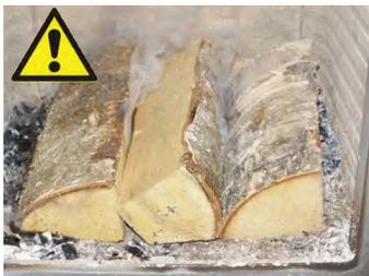
炭が少なすぎる熾き床に薪を足してしまった例です。空気の流れが悪いので、空気が不足し、煙が発生しています。
