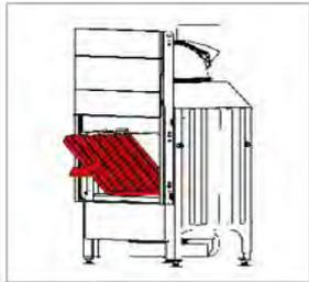
1. サイドの断熱シートを外します。
