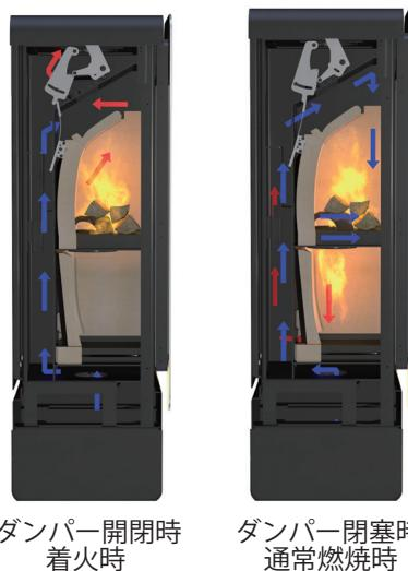
着火時の燃焼用空気は上部燃焼室に入り、薪を燃焼させ、煙は上部燃焼室の上部より抜けて煙突へと流れます。ストーブが適切な温度に達すると、自動でダンパーが閉じて煙の流れを変えます。煙に含まれる未燃焼ガスが、上部燃焼室のドームトップを通り、下部燃焼室へ誘導されます。ドームトップから下部燃焼室に流れ込む時に、二次燃焼用の空気が後部より入り込み、二次燃焼を促して下部燃焼室に勢いよく炎が噴射されます。この炎は上部燃焼室の薪が燃え尽きていくことによって勢いが弱まります。
